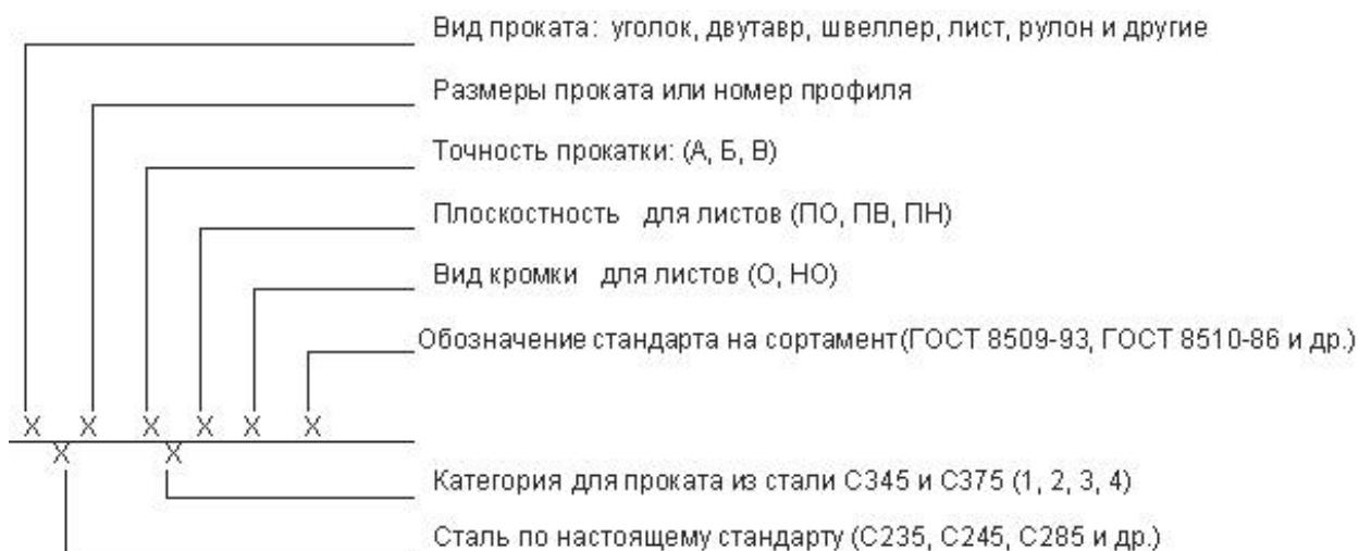
Прокат угловой равнополочный, обычной точности прокатки (В), размерами 75x75x6 мм по ГОСТ 8509-93, из стали С245 по настоящему стандарту:
